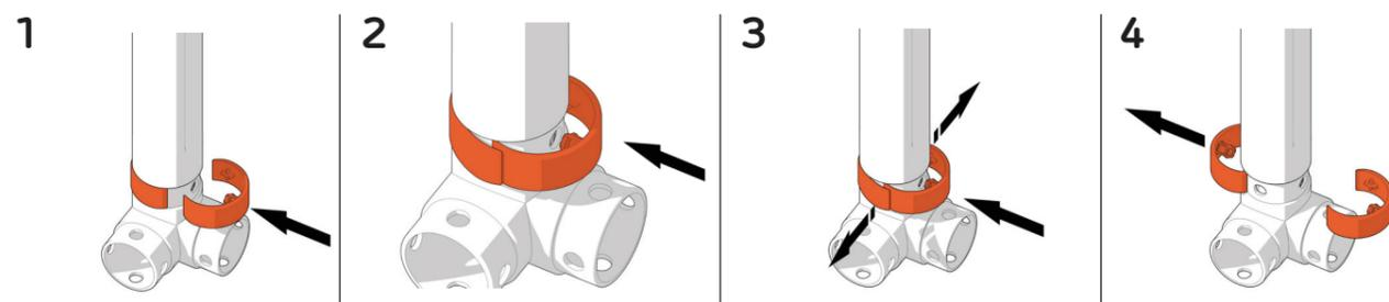
Demontage der Konnektoren und Rohre/Disconnecting the connectors and tubes/
