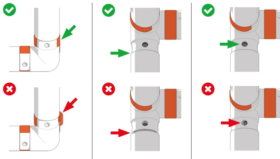
Entfernen der Klammer/Opening of clips/Ouverture de la parenthèse
