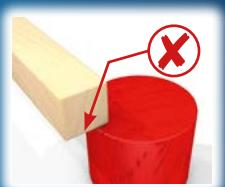
L'extrémité de la réglette ne repose **pas entièrement** sur le pilier.
