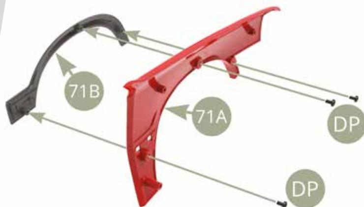
Positionner l'aile avant gauche 71A sur l'avant gauche du châssis 68A et la fixer avec trois vis BM (illustrations ci-dessus et ci-dessous).
