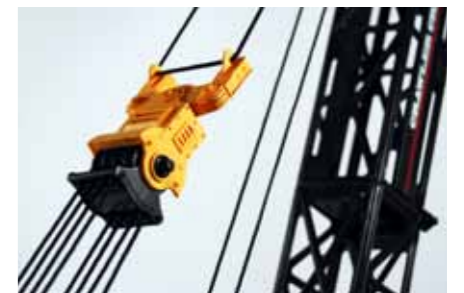
Vor dem ersten Betrieb sollte darauf geachtet werden, dass die Bänder alle parallel zueinander liegen und sich nichts versehentlich verheddert hat
