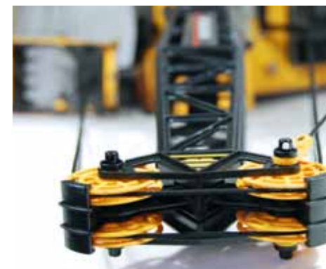
Blick auf die Spitze: der Greifer wird über ein Seil geöffnet und geschlossen
