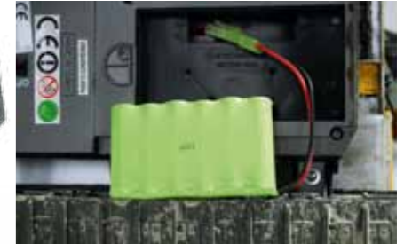
Der Fahrakku mit 800 Milliamperestunden Kapazität ist samt Ladegerät bereits enthalten und wird in einer Kammer am Fahrzeugboden angeschlossen
