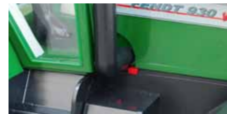
Zum Binden des Modells mit der im Lieferumfang enthaltenen 2,4-Gigahertz-Fernsteuerung genügt ein kurzer Druck auf diese unscheinbare rote Taste
