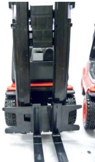
Die neue Technik befindet sich unglücklicherweise im Sichtfeld des Fahrers
