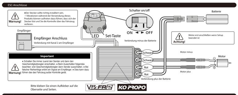
Der Standard und die entsprechenden Einstellungen werden über das Signal des Senders im VFS-FR2 gespeichert. Die Einstellungen werden gespeichert und gehen auch dann nicht verloren, wenn die Stromversorgung ausgeschaltet wird.
