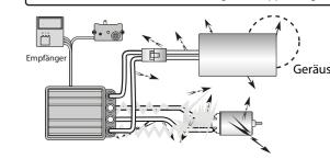
Bitte installieren Sie den Empfänger und das Antennen-Geräusche kabel so, dass eine Isolation von Geräuschquellen besteht.
