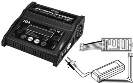
Skizze für Anschluss des Balancer-Steckers bei Laden mit Balancer, Storage und Entladen.
