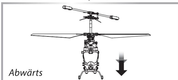
Wenn Sie den linken Hebel (Gas) herunterziehen, reduziert sich die Geschwindigkeit der Hauptrotorblätter und der Hubschrauber sinkt.
