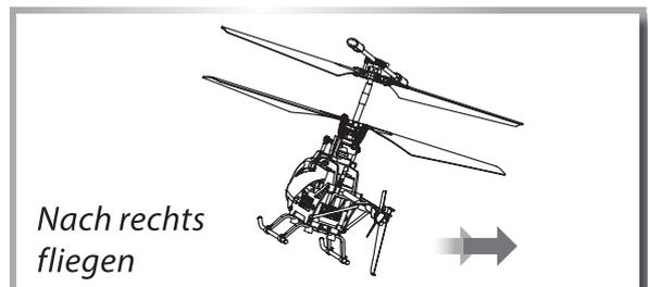
Schieben Sie den Heckrotorfunktionshebel nach rechts, der Hubschrauber fliegt nach rechts.
