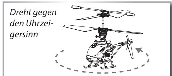
**Trimmung:** Wenn der Helikopter in eine Richtung wegdreht, kann per Trimmung nachjustiert werden, so dass der Helikopter gerade fliegt.
