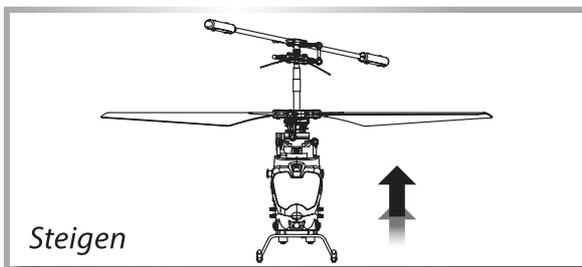
Wenn Sie den linken Hebel (Gas) hochschieben, läuft der Hauptrotor schneller und der Hubschrauber steigt.
