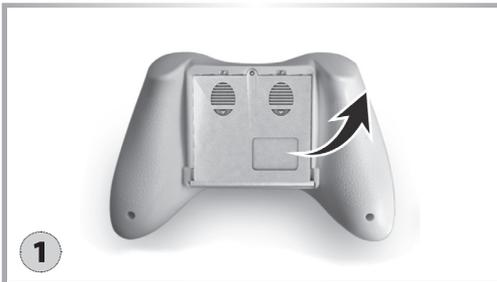
Die Schraube vom Batterie-Deckel herausdrehen. Nehmen Sie den Batterie-Deckel ab.
