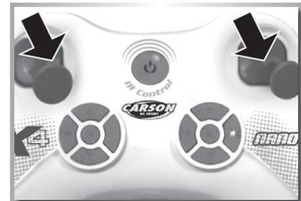
**Kalibrierungs Funktion:** Falls der Quadcopter nach dem Start immer auf eine Seite abdriftet, sollten Sie das 2,4 GHz Signal nochmal neu binden und das Modell dabei auf eine horizontale Fläche (Tisch, Fußboden) stellen. Anschließend bringen Sie die beiden Steuerhebel bei eingeschaltetem Zustand in die Position rechts unten (Abb.), bis die LED's blinken. Dann ist die Kalibrierung abgeschlossen.
