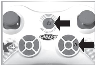
**MODE Auswahlschalter:** Sie können zwischen Mode 1 und Mode 2 wählen. Drücken Sie Knopf A und schalten Sie dann den Sender an, um Mode 1 zu wählen. Wenn Sie den Vorgang wiederholen wählen Sie wieder Mode 2 aus.
