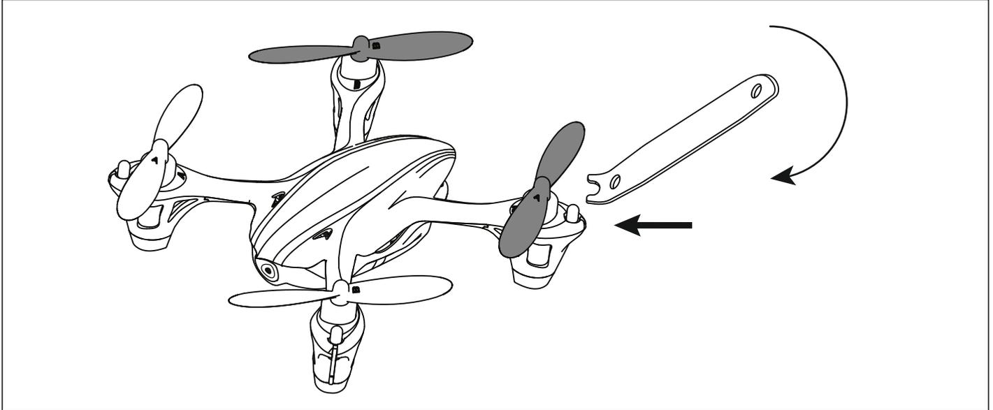
Schieben Sie das Montagewerkzeug wie im Bild gezeigt unter den Propeller und hebeln Sie den Propeller nach oben weg.
