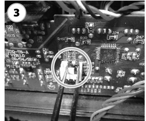
3. Finden Sie das Anschlusselement mit den 3 Pins und platzieren Sie den Anschlussdraht an das Anschlusselement mit den 2 Pins.
