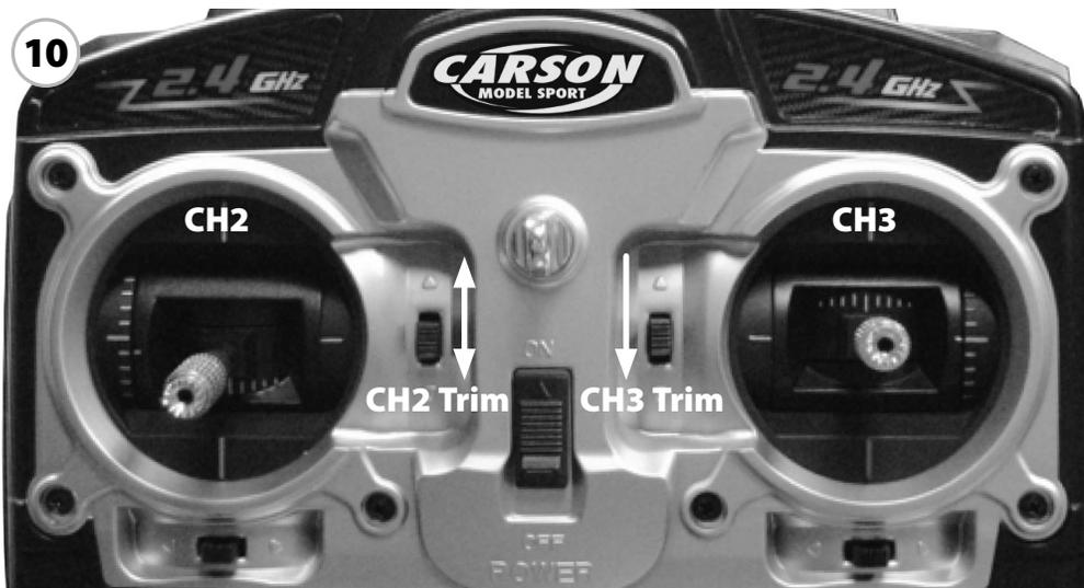
8. Wenn die Rückseite geschlossen ist, schalten Sie bitte den Sender ein, für ein Reset der Trimmung.
