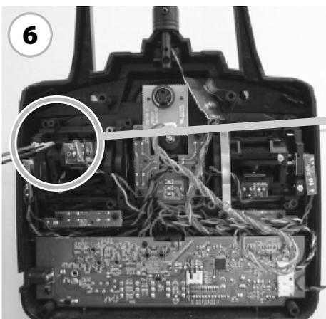
6. Entfernen Sie die Feder vom Nick und befestigen Sie sie an Gas.
