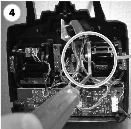
4. Entfernen Sie die Feder für den Steuerknüppel (Bild 4).
