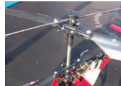
Der obere Rotor ist über ein Gestänge mit der um 45 Grad versetzten Stabilisierungsstange verbunden – das Geheimnis für die enormen Flugstabilität
