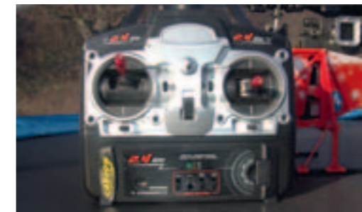
Der Sender kann auch auf Mode 1 umgebaut werden. Gas lässt sich bei Bedarf umpolen (für Piloten mit Leerlauf vorn)
