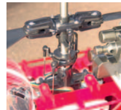
Die Anlenkung des unteren Rotors erfolgt über zwei Gestänge, die sauber in einer Führung laufen und mit der darunterliegenden Taumelscheibe verbunden sind. Die Servos für Nick und Roll sitzen in der Einbaumechanik
