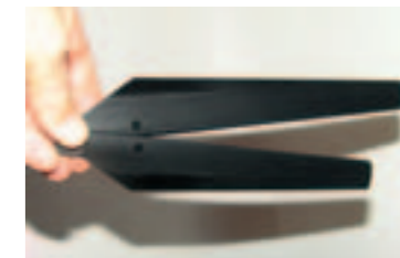
Kein Versehen, sondern konstruktiv so gewollt: Oberer und unterer Rotor haben verschiedene Blattlängen. Sie differieren um 30 Millimeter
