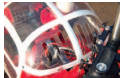
In der Kanzel sind Lüftungsschlitze für die darunter liegende Bordelektronik eingearbeitet
