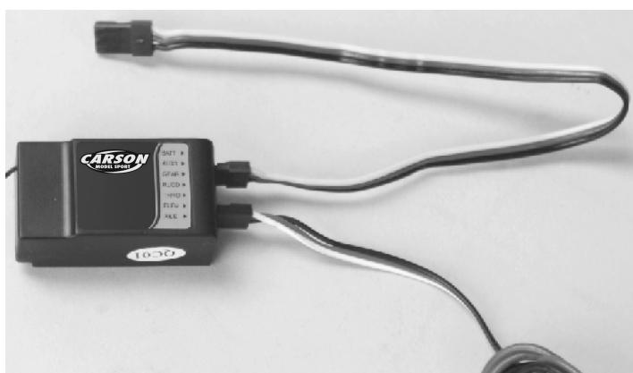
5. Disinserire il connettore Binding. Il LED continua a rimanere acceso per alcuni secondi. Il sistema RC ritorna alla modalità normale.
