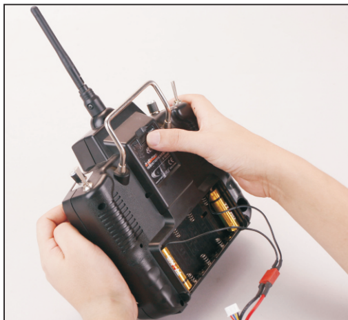
1. 按下发射机的对频开关, 打开电源.
