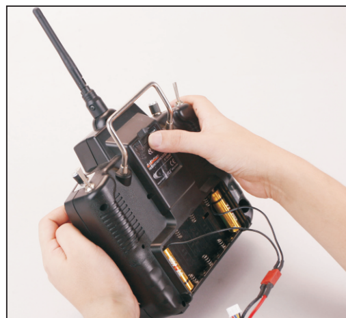
4. 弹起发射机的对频开关, 发射机进入工作模式.
