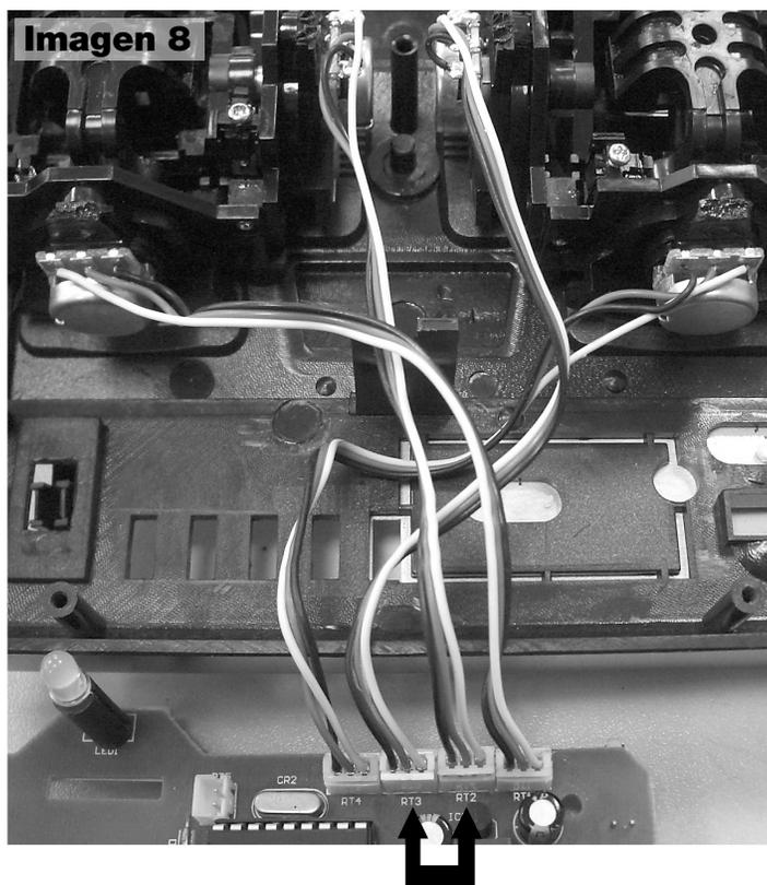
Cierre la carcasa con ayuda de los cuatro tornillos de cabeza ranurada en cruz. Vigile de no aplastar ningún cable durante el montaje.
