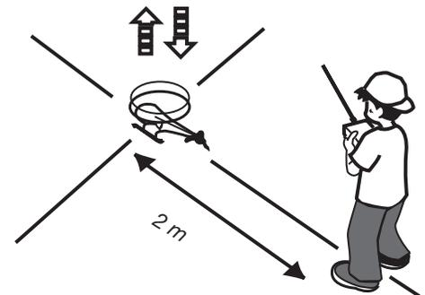
La LED (1) sur le récepteur commence à clignoter. Cela indique l'auto-étalonnage du circuit du gyroscope électronique.
