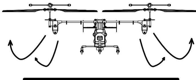
C'est pourquoi le comportement en vol d'un hélicoptère est plutôt instable à basse altitude. En cas de difficultés avec ce comportement en vol instable, il est préférable de monter progressivement.
