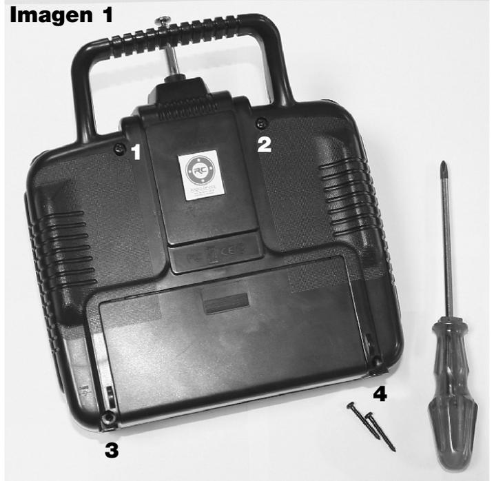
Una vez abierta la carcasa, el muelle de la palanca de dirección y el clip metálico de la palanca de acelerador pueden ser retirados utilizando un destornillador de estrella.
