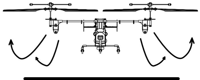
Por esta razón, el comportamiento de vuelo del modelo a baja altura es más bien inestable. En caso que este agitado comportamiento de vuelo le ocasione problemas, eleve paulatinamente la altura de vuelo.
