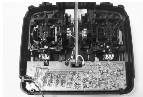
Auf der rechten Seite fädeln Sie wie in Bild 4 die Wippe mit Feder ein. Der Federspanner wird mit der Kreuzschlitzschraube montiert und die Feder anschliessend wieder mit Hilfe einer Pinzette eingehängt.
