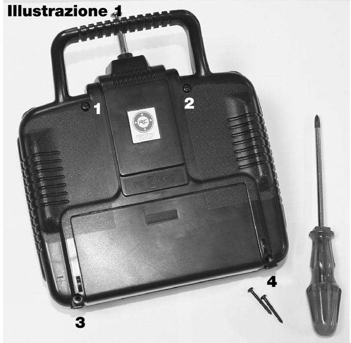
Una volta aperto il coperchio del trasmettitore, rimuovere la molla dello stick di direzione e la barretta dello stick acceleratore, aiutandosi con un piccolo cacciavite a stella.
