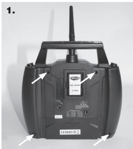
1. Desenroscar los tornillos de la tapa del transmisor como se muestra en la figura.
