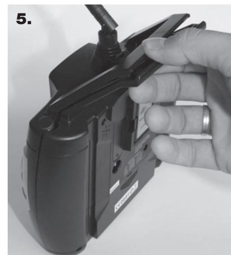
Befestigen Sie den Stift D. Befestigen Sie die Rückabdeckung und ziehen Sie die Schrauben an. Bewegen Sie den Schubregler in die niedrigste Position. Damit ist der Umbau abgeschlossen.
