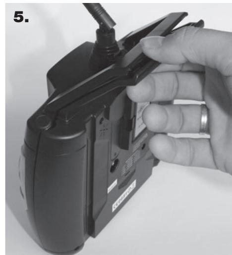
Remettez la goupille D. Remettez la partie arrière et serrez les vis, puis placez la manette des gaz dans la position la plus basse. Le changement de mode est terminé.
