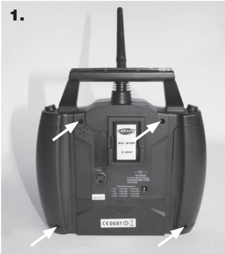
Lösen Sie wie auf dem Bild dargestellt die Schrauben am Gehäuse des Senders.
