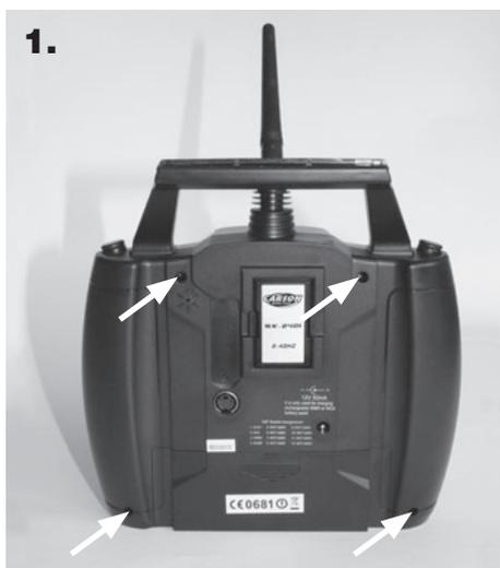
Lösen Sie wie auf dem Bild dargestellt die Schrauben am Gehäuse des Senders.
