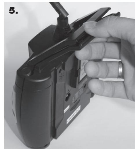
5. Colocar el pin D. Montar la tapa trasera y apretar los tornillos, y desplazar la palanca a su posición más baja. Ha concluido el proceso de conmutación.
