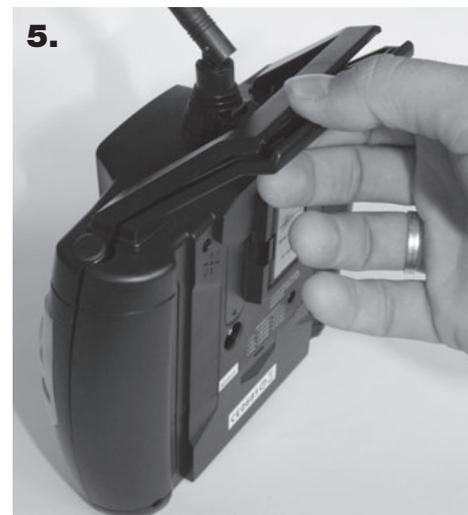
Inserire il perno D. Montare il coperchio posteriore e serrare le viti, quindi spostare il trim della manetta nella posizione inferiore. La procedura è terminata.
