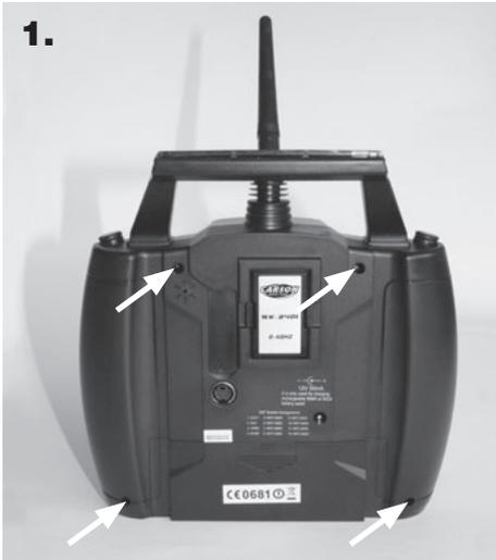
Desenroscar los tornillos de la tapa del transmisor como se muestra en la figura.
