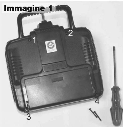
Una volta aperto il coperchio del trasmettitore, rimuovere la molla dello stick di direzione e la barretta dello stick acceleratore, aiutandosi con un piccolo cacciavite a stella.
