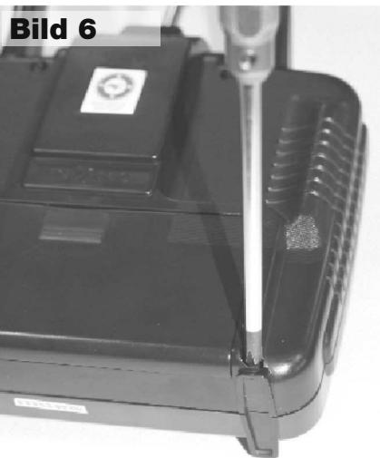
Bevor Sie Ihr Modell in Betrieb nehmen, müssen die beiden mittleren Servoreverse Schalter auf der Vorderseite Ihres Senders in die obere Position gebracht werden.
