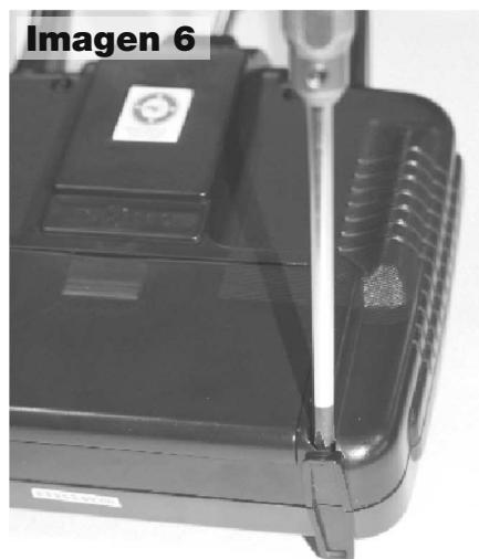
Antes de que su helicoptero pueda ser puesto en marcha, los dos inversores de servo centrales en la parte delantera de la emisora deben ser puestos hacia arriba.
