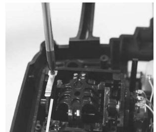
Jetzt müssen Sie den Metallraster (B) gemäß Abb. 3 auf der linken Seite montieren.
