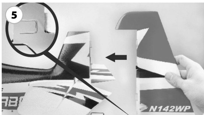
Nun das Seitenruder vorsichtig auf das Leitwerk stecken.
