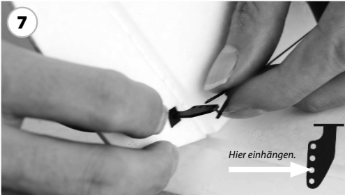
Montieren Sie das Anlenkgestänge am Gestängeanschluss des Seitenruders.
