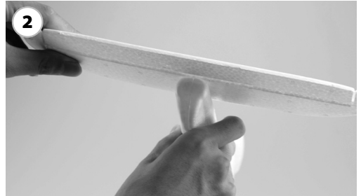
Montieren Sie das Höhenleitwerk nun an das Heck des Rumpfes.
