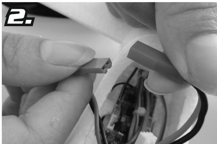
Verbinden Sie den Akkustecker mit dem Anschluss im Modell. Die Rote LED am Modul leuchtet nun.
