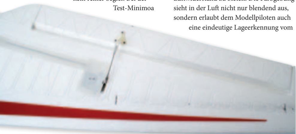
Durch die sehr feine Oberfläche des Hartschaums sind sogar Rippen und Spanten angedeutet
