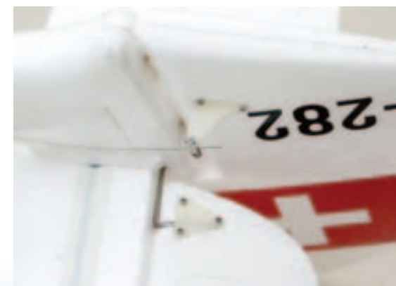
Die Mittelstellung des Bowdenzugs am Seitenruder lässt sich stufenlos über eine Klemmung justieren
