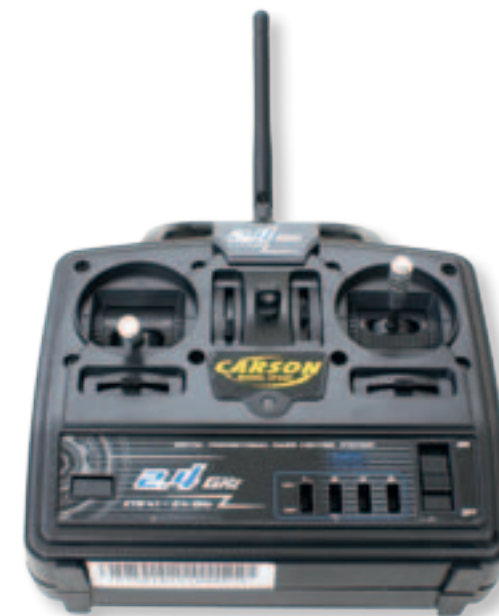
Die 2,4-Gigahertz-Fernsteuerung bietet alle nötigen Einstelloptionen und ist ideal für den Betrieb des Modells geeignet
