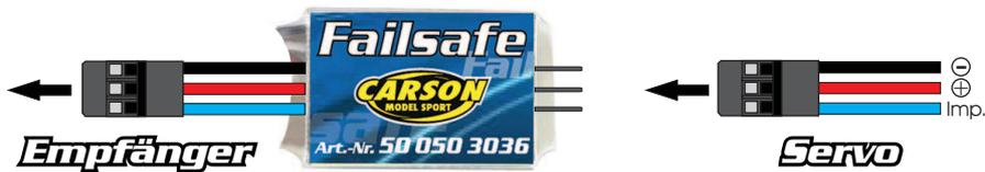
Am Eingang "+", "-" und "Impuls" ist ein 3poliges Kabel (Servokabel) mit einem für Ihre Empfangsanlage passenden Stecker unter Beachtung der Polarität angelötet. Am Ausgang ist entsprechend ein Buchsenkabel angebracht.
