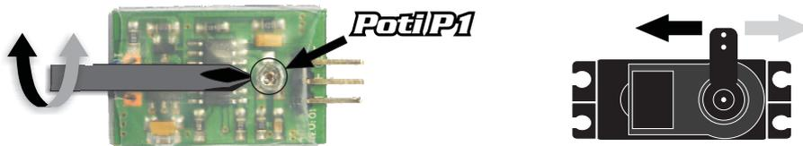
Schalten Sie erst jetzt den Sender ein und testen Sie, ob das Servo wie gewohnt per Steuerknüppel zu handhaben ist. Nach einem (simulierten) Senderausfall per Abschaltknopf muss das Servo wieder in seine Notstellung fahren. Die vorliegende Failsafe-Schaltung kann nun nach dem erfolgtem Funktionstest nochmals mit einem passenden Schrumpfschlauch Überzogen und eingeschrumpft werden. Danach wird diese an geeigneter Stelle befestigt und für den vorgesehenen Zweck in Betrieb genommen.
