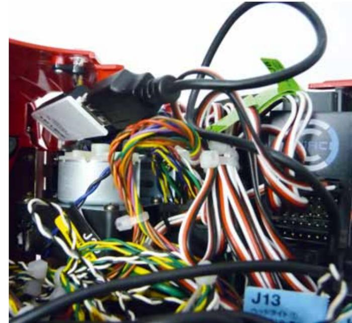
Die relativ dicken und langen USB-Kabel sind schwer zu bändigen. Gerade bei kleineren Modellen dürfte die Verkabelung der WiRC-Anlage Probleme bereiten
