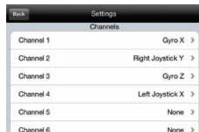
In dieser Einstellung wird das Fahrzeug über Neigen und Kippen des Handys gefahren und gelenkt
