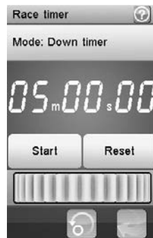
In diesem Beispiel wird der Down-Timer auf 5 Minuten eingestellt, ist jedoch noch angehalten.
