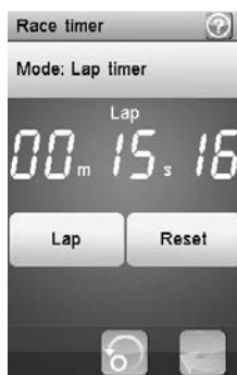
In diesem Beispiel wurde die Runden-Schaltfläche gerade berührt und die Runden-Zeit wird drei Sekunden lang angezeigt.
