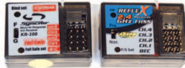
Die beiden Vierkanalempfänger, KR-200 (links) und Reflex (rechts), sind baugleich. Beide verfügen über eine Failsafe-Funktion sowie einen Umschalter für den Funkbetrieb in Frankreich. Das Gewicht beträgt jeweils 10 Gramm
