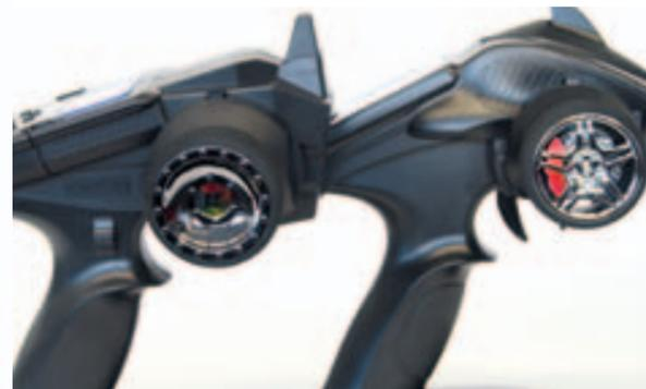
Die Lenkräder unterscheiden sich nur im Design voneinander. Ein Vorteil der Kyosho-Funke (links) ist, dass sich der Schalter für den dritten Kanal am Griff befindet. Bei der Carson-Funke ist dieser an der Front, vor dem Lenkrad untergebracht
