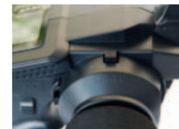
Beide Fernsteueranlagen sind mit digitalen Trimmungen für den ersten und zweiten Kanal ausgestattet. Hier im Bild die Syncro KT-201
