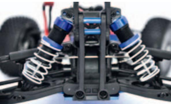
Mit den Rändelmuttern lässt sich die Bodenfreiheit des Modells stufenlos einstellen
