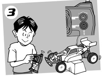
Das RC-Auto zur Überprüfung der richtigen Funktion auf eine Schachtel oder eine Art Ständer stellen. Falls die Räder sich weiterdrehen, die Gastrimmung nachstellen.
