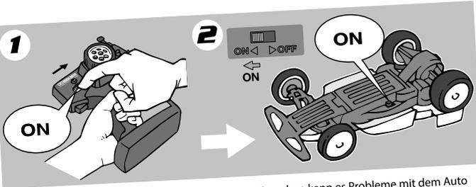
Zuerst den Sender, dann das RC-Auto einschalten. Achte beim Einschalten deines RC-Autos auf diese Reihenfolge. Bei fehlerhaftem
