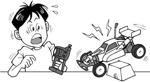
Falls das Auto von selbst losfährt, obwohl der Gaszugriff auf neutral steht, ist die Gastrimmung nachzustellen. Den Knopf in die Stellung drehen, bis die Reifen aufhören, sich zu drehen.
