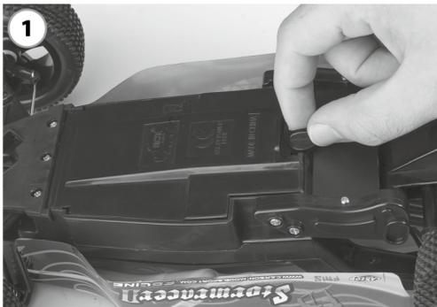
Den Knopf an der Unterseite des Chassis in die angegebene Richtung drehen und Batterieabdeckung aufklappen.
