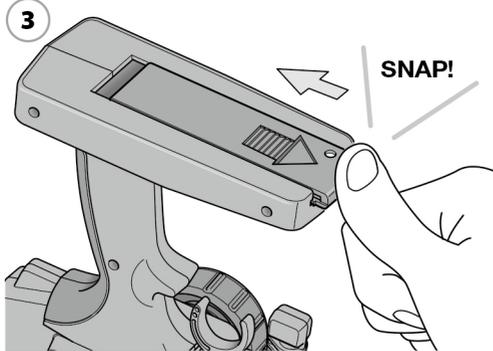
Richtiges Einlegen der Batterie überprüfen und Batterieabdeckung schließen.
