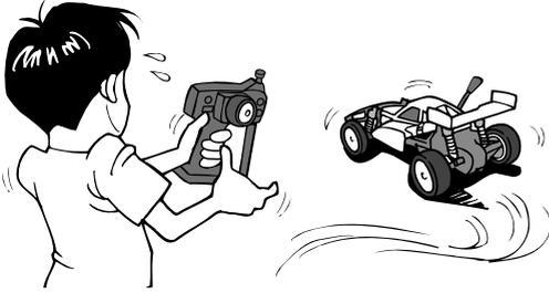
Fährt das RC-Auto nicht geradeaus, ist die Lenkstrimmung nachzustellen. Lassen Sie das Auto ohne Betätigung des Lenkrades fahren, um die Richtung festzustellen und korrigieren Sie durch Drehen am
