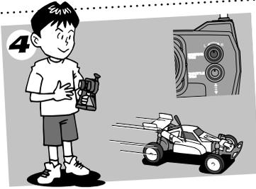
Lasse das Auto ohne Betätigung des Lenkrads langsam losfahren. Falls das RC-Auto nicht geradeaus fährt, die Lenkungstrimmung nachstellen.
