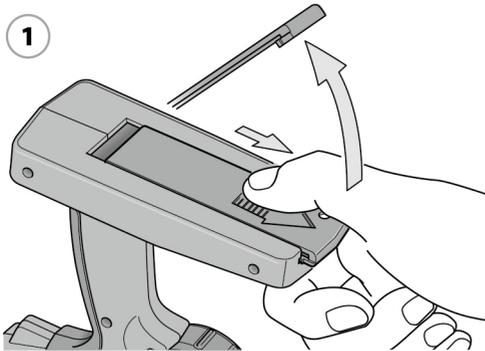
Batterieabdeckung in die angezeigte Richtung schieben und öffnen.
