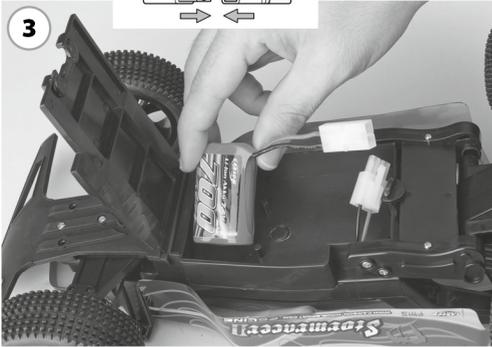
Den aufgeladenen Akku an das RC-Auto anschließen und einlegen.
