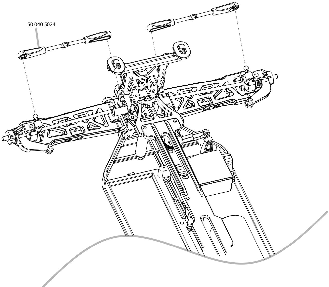
**16. Montage Lenkung • Steering Assembly**
