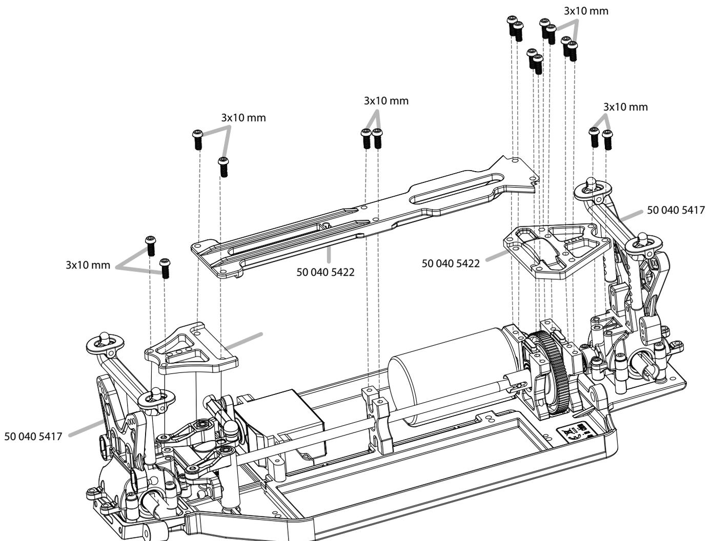
**13. Montage Antrieb vorne • Front Drive Assembly**
