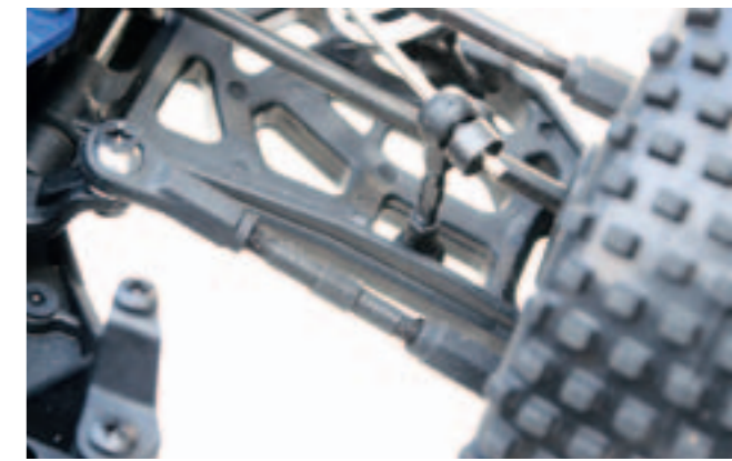
Über Rechts-links-Gewindestangen lassen sich Sturz und Spur stufenlos einstellen
