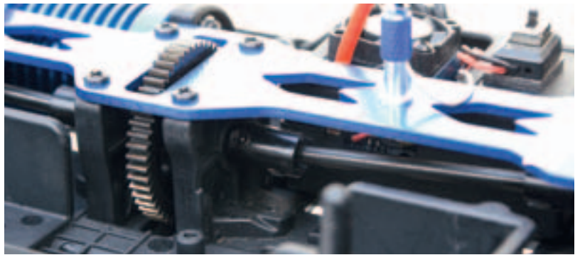
Ritzel und Hauptzahnrad laufen ungekapselt. Steinchen haben, dank der richtigen Werkstoff- und Verzahnungswahl, trotzdem keine Chance, Schaden anzurichten
