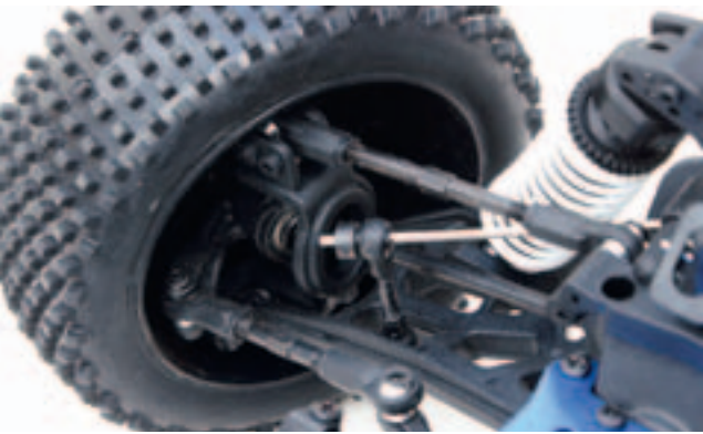
Die Vorderachse verfügt über C-Hubs und bietet zahlreiche Einstellmöglichkeiten
