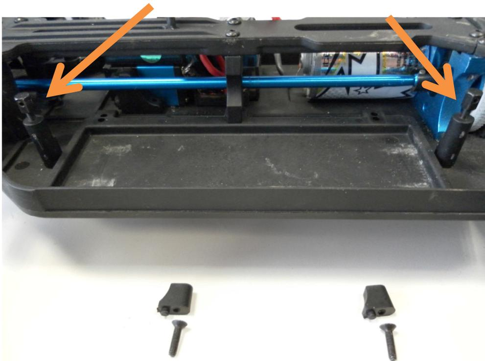
Zu Abschluss muss noch die Akkuhalterung (Befestigungsbügel) gedreht werden (Unterseite <=> Oberseite) und schon können problemlos Akkupacks mit bis zu 4500 mAh Kapazität im **Dirt Warrior** gefahren werden.
