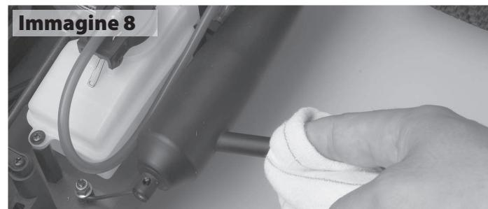
Applicare dall'apertura del carburatore un olio "After Run" e dare dei colpetti con lo strappo, in maniera da metterlo in circolo. Questo passo è necessario se non utilizzate la macchina per più di un giorno, in quanto il metanolo evaporando lascia dei residui di acqua che sono dannosi per il motore. È consigliabile controllare sempre che tutte le viti ed i dadi siano ben stretti ed ove necessario applicare del freno filetti.
