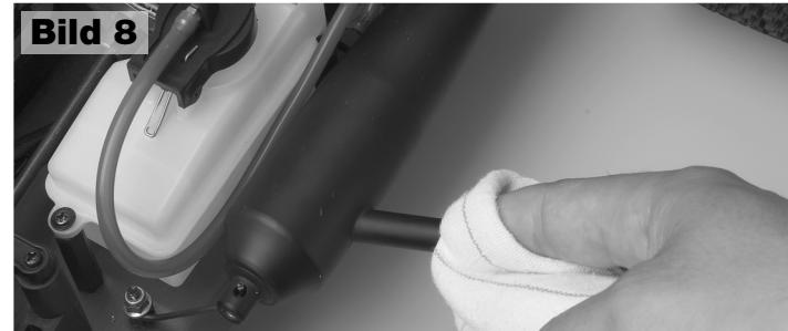
Benutzen Sie dann spezielles Öl (After-run Öl) für den Vergaser, ziehen Sie das Startseil ein paar Mal, damit sich das Öl im Motor verteilt. Dieser Vorgang empfiehlt sich, wenn Sie planen, das Auto mehr als einen Tag nicht zu fahren. Methanol verdunstet und wird zu Wasser, was für die Teile im Inneren des Motors schädlich sein kann. Wir empfehlen, dass Sie vor jedem Gebrauch Ihres Autos die Festigkeit aller Schrauben, Muttern und Bolzen überprüfen.
