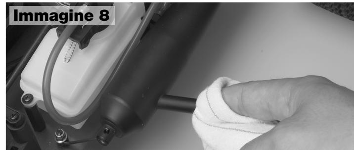
residui di acqua che sono dannosi per il motore. E' consigliabile controllare sempre che tutte le viti ed i dadi siano ben stretti ed ove necessario applicare del frena filetti. Mantenere la macchina pulita aiuta anche a lavorarci intorno. Per pulire si può utilizzare un compressore ad aria, o appositi prodotti spray o a pennello.
