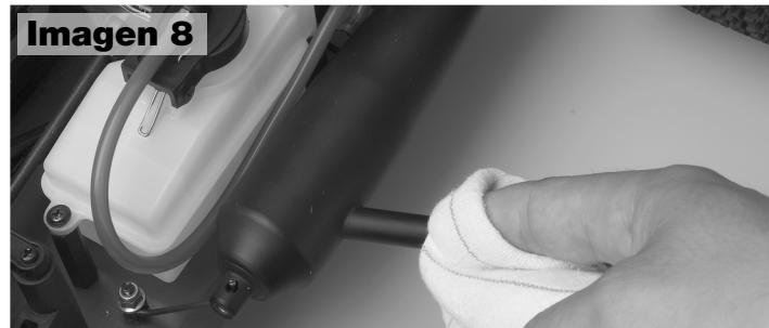
A continuación aplique aceite "after run" a través del carburador, y accione el tirador unas cuantas veces para repartirlo dentro del motor. Esto se recomienda si planea no utilizar el coche durante más de un día. El metanol se evapora en agua, que no es buena para las partes internas del motor. Siempre es buena idea revisar todos los tornillos, tuercas y pasadores antes de cada sesión de uso. Mantener el coche
