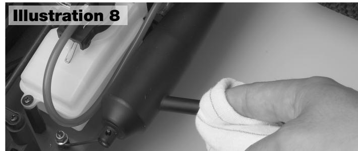
et écrous avant et après chaque utilisation. Maintenir le modèle le plus propre possible pour pouvoir en profiter longtemps. Pour cela, utiliser un pinceau ou une soufflette. Toujours vérifier les batteries d'émission et de réception avant de démarrer la voiture.
