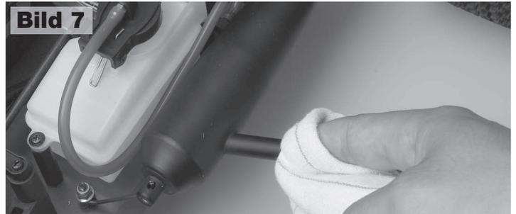
Benutzen Sie dann spezielles Öl (after-run Öl) für den Vergaser, ziehen Sie das Startseil ein paar Mal, damit sich das Öl im Motor verteilt. Dieser Vorgang empfiehlt sich, wenn Sie planen, das Auto mehr als einen Tag nicht zu fahren. Methanol verdunstet und wird zu Wasser, was für die Teile im Inneren des Motors schädlich sein kann. Wir empfehlen, dass Sie vor jedem Gebrauch Ihres Autos die Festigkeit aller Schrauben, Muttern und Bolzen überprüfen.
