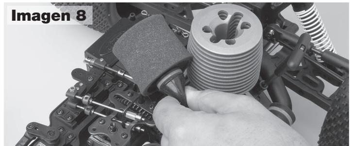
que sea más agradable trabajar en él. Esto se puede lograr con un compresor grande similar a los utilizados para pintar o con aire comprimido. Compruebe siempre las baterías de la emisora y receptor antes de arrancar el motor.
