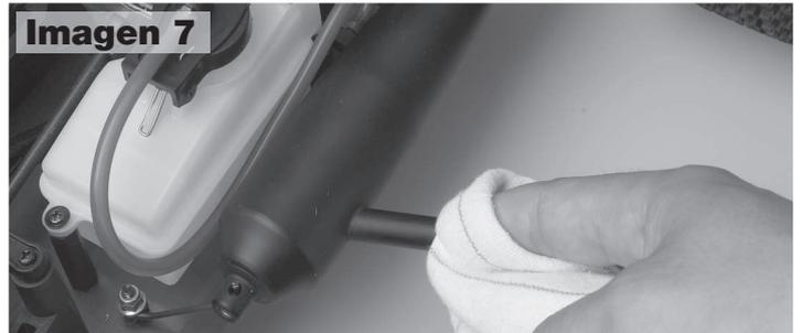
A continuación aplique aceite "after run" a través del carburador, y accione el tirador unas cuantas veces para repartirlo dentro del motor. Esto se recomienda si planea no utilizar el coche durante más de un día. El metanol se evapora en agua, que no es buena para las partes internas del motor. Siempre es buena idea revisar todos los tornillos, tuercas y pasadores antes de cada sesión de uso. Mantener el coche limpio hará
