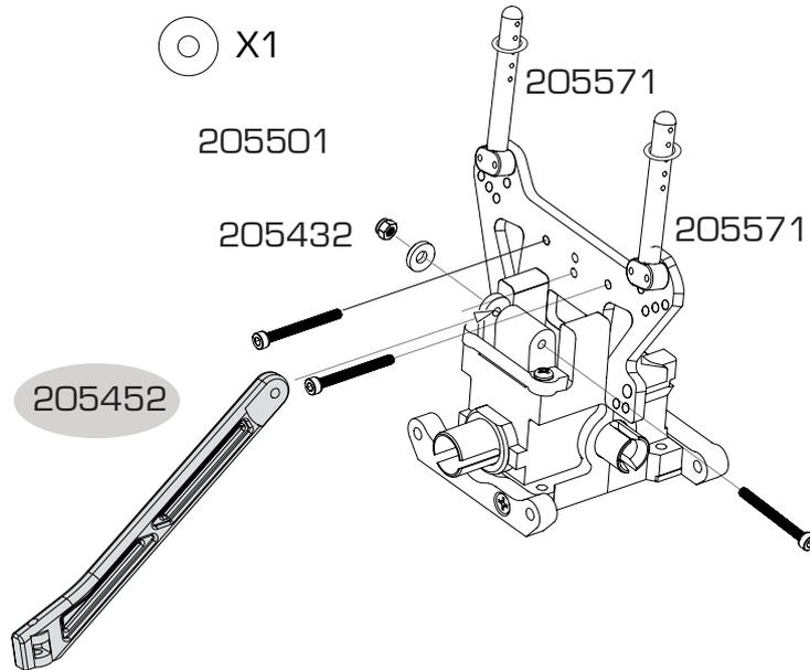
**Front Absorber Bridge • vordere Dämpferbrücke • Support d'amortisseur avant • Soporte de amortiguadores delantero • Attacco Ammortizzatore Anteriore**
