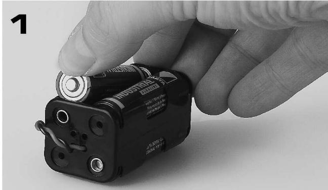
Legen Sie 8 „AA“ Batterien in den Sender (siehe Bild 2). Achten Sie auch hier auf die richtige Polung. Schließen Sie die Abdeckung und schalten Sie die Fernbedienung ein. Die LED leuchtet auf, dies bestätigt, dass die Fernbedienung eingeschaltet ist.
