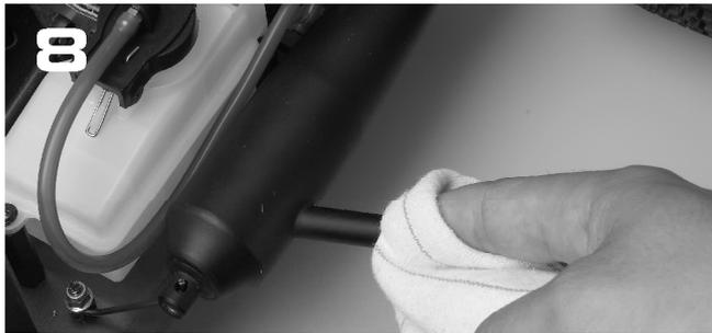
Die zweite Möglichkeit besteht darin, den Luftzugang zum Motor abzuklemmen. Der Kraftstoffschlauch sollte nicht abgeklemmt werden, weil sich der Motor dadurch überhitzen kann. Versuchen Sie den übrig gebliebenen Kraftstoff durch den Motor laufen zu lassen, um so den Tank vollkommen zu entleeren. Die Motordrehzahl wird sich im Leerlauf erhöhen während der Tank sich entleert, somit sind die o.g. Schritte nicht nötig.
