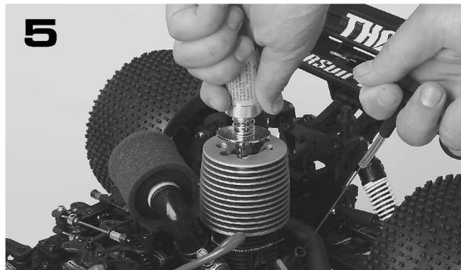
Sollte der Motor Probleme im Leerlauf haben, drehen Sie bitte die Schraube für den Leerlauf im Uhrzeigersinn immer um 1/8 Schritte weiter. Das erhöht den Leerlauf, was ein korrektes Einfahren des Motors ermöglicht. Führen Sie diesen Vorgang nur in einem gut durchlüfteten Raum durch, vorzugsweise im Freien, z.B. Ihrer Einfahrt. Nicht verbranntes Öl des Kraftstoffes
