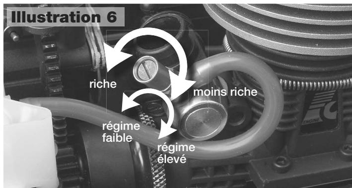
Pointeau de reprise : le pointeau doit affleurer la commande, visser ensuite d'un tour dans le sens des aiguilles d'une montre.
