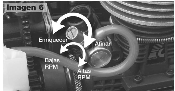
Aguja de bajas (en leva de apertura): Enrásela con el borde de la leva, a continuación gire a la derecha una vuelta completa;
