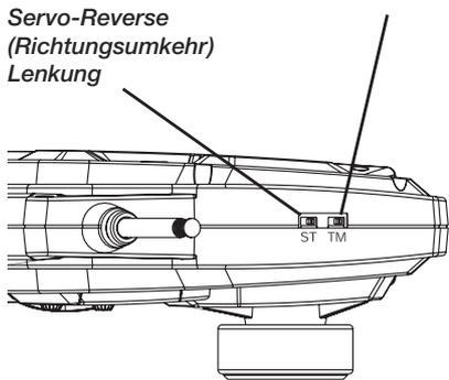
Servo-Reverse (Richtungsumkehr) Gas/Bremse
