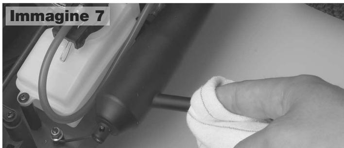
controllare sempre che tutte le viti ed i dadi siano ben stretti ed ove necessario applicare del frena filetti. Mantenere la macchina pulita aiuta anche a lavorarci intorno. Per pulire si può utilizzare un compressore ad aria, o appositi prodotti spray o a pennello.
