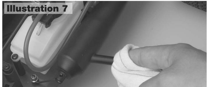
et écrous avant et après chaque utilisation. Maintenir le modèle le plus propre possible pour pouvoir en profiter longtemps. Pour cela, utiliser un pinceau ou une soufflette. Toujours vérifier les batteries d'émission et de réception avant de démarrer la voiture.
