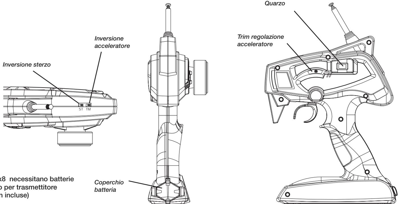
AAx8 necessitano batterie stilo per trasmettitore (non incluse)
