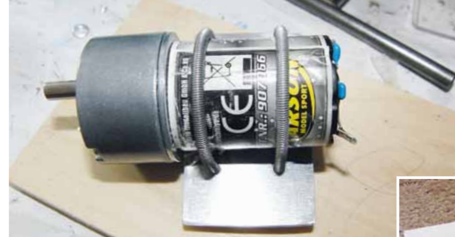
Der Getriebemotor wird mittels gebogenen 3-Millimeter-Gewindestäben auf sein Halblech gepresst
