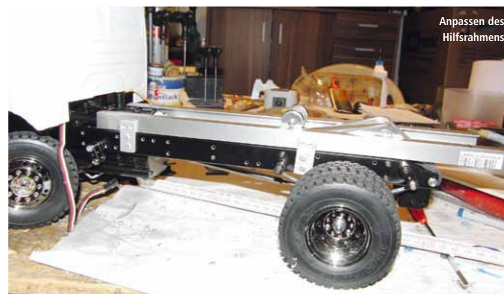
Die Servos wurden vor der Achse platziert. Als Spurstange dient eine zurechtgebogene Gewindestange
