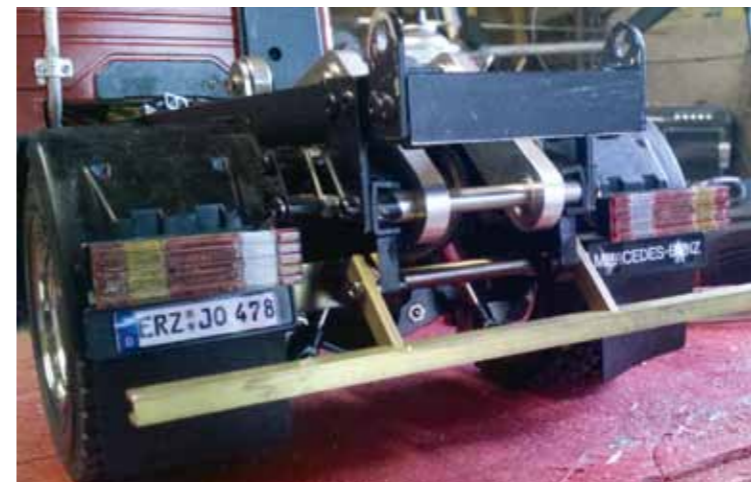
Aus Messing-U- und -Flachprofil wurde der hintere Unterfahrschutz gelötet
