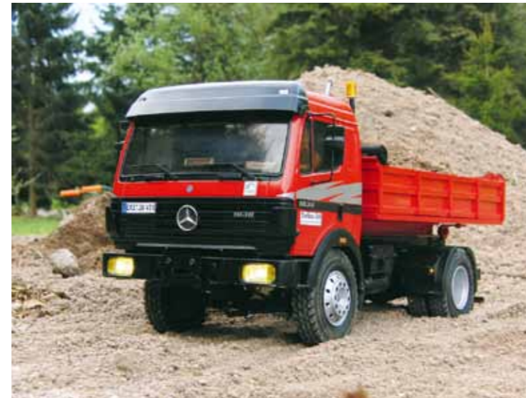
Die abgeschnittene Stoßstange sorgt vorn für genügend Bodenfreiheit
