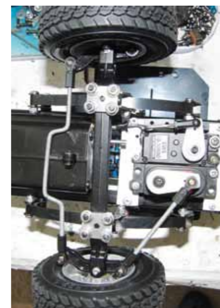
Die Servos wurden vor der Achse platziert. Als Spurstange dient eine zurechtgebogene Gewindestange
