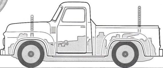
★スナップピンの位置は、ボディがタイヤや路面に接触しない高さに取り付けてください。
