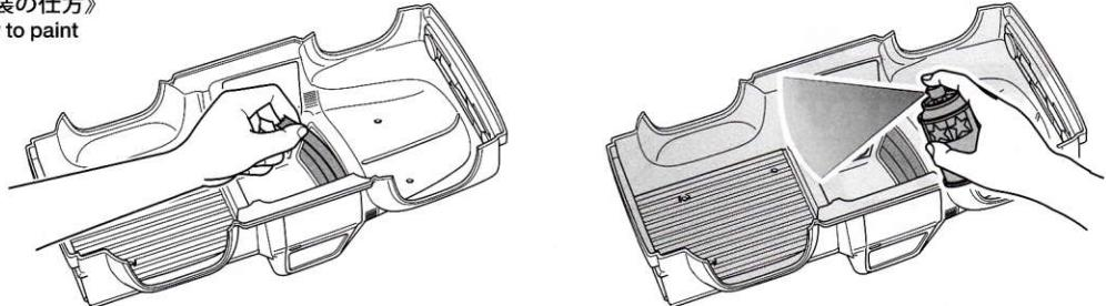
① ★ボディを中性洗剤で洗い、よく乾かした後、ボディ内側のウインドウ部をマスキングテープ（別売）でマスキングします。その後、ホワイト（PS-1）で塗装する部分、次にシルバー（PS-12）で塗装する部分を順にマスキングしてください。
