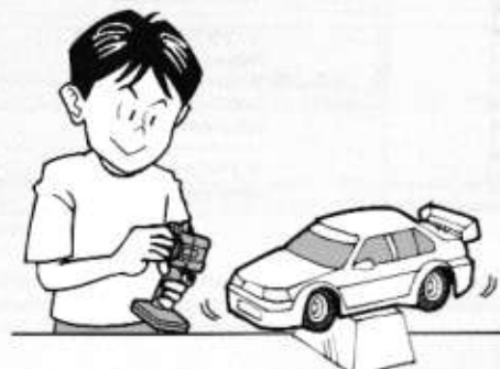
3 走らせる前にRCカーを台の上に乗せ、各部の動きをチェックします。
