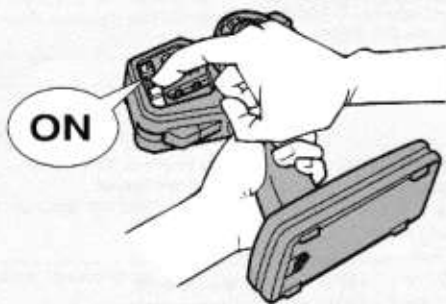
1 送信機のアンテナをのぼし、スイッチをONにします。
