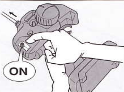
① 送信機のアンテナをのぼし、スイッチをONにします。
