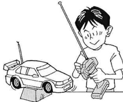
③ 走らせる前にRCカーを台の上に乘せ、各部の動きをチェックします。
