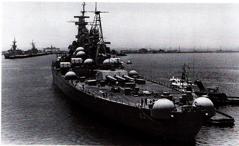
●1983年、改修のため移動中のミズーリ。再使用を考慮して対空兵器を保護するお椀状のモスボールと呼ばれるドームが取り付けられている。
