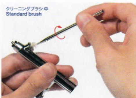
《クリーニングブラシ 極細》①クリーニングブラシにエアブラシクリーナーをしみこませて、ニードルが通る細い穴をクリーニングします。②軸の中間部分(洗浄に必要な長さ)を持って、ゆっくり前後に動かしたり回転させてください。③溶けた塗料汚れはクラフト綿棒などできれいにふき取ってください。④汚れがひどい場合は、クリーニングブラシをエアブラシクリーナーで洗浄し、作業を繰り返してください。
