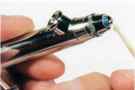
●洗浄したパーツはクリーナーで脱脂された状態になっています。つまようじを使ってネジ部（水色アミ■の部分）に高粘度グリスを薄く塗ってください。エア漏れを防いでスムーズな吹き付けができ、ネジ部の磨耗防止にもなります。★塗り過ぎにご注意ください。はみ出したグリスはクラフト綿棒でふき取ってください。塗料が通る部分にグリスがしみ出すと、塗料のハジキ（塗装不良）の原因になります。
