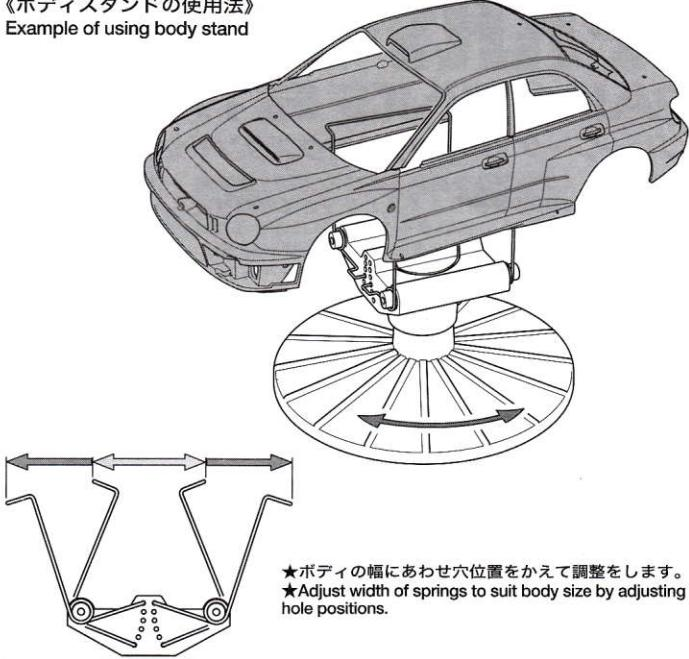
★ボディの幅にあわせ穴位置をかえて調整をします。
