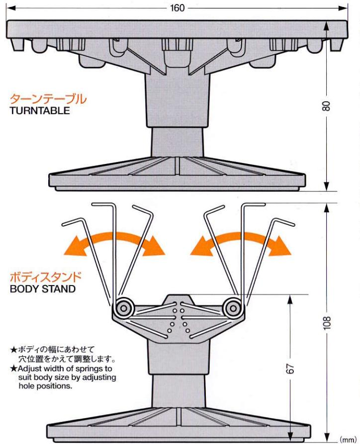
エアーブラシやスプレー塗装の作業効率を高める2種類のペイントイングスタンドをセットしました。直径16cmのターンテーブルは数種類の穴があり、パーツを付属のクリップで挟んで固定したり、ランナー枠ごと固定することが可能。ボディスタンドは1/24スケールのカーボディなどを簡単に固定できます。どちらのスタンドも手で自由に回転させることができ、スプレーワーク・ペイントイングベース(別売)内での作業に最適なサイズです。
