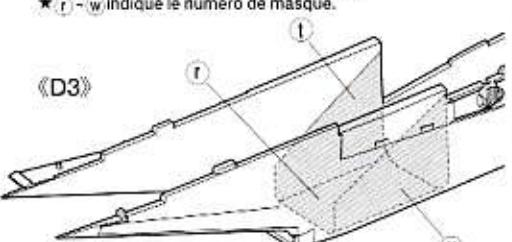
① ★内部をフラットホワイト(XF-2)で塗装した後、マスクシールを切り出して、指示の位置に貼ります。
