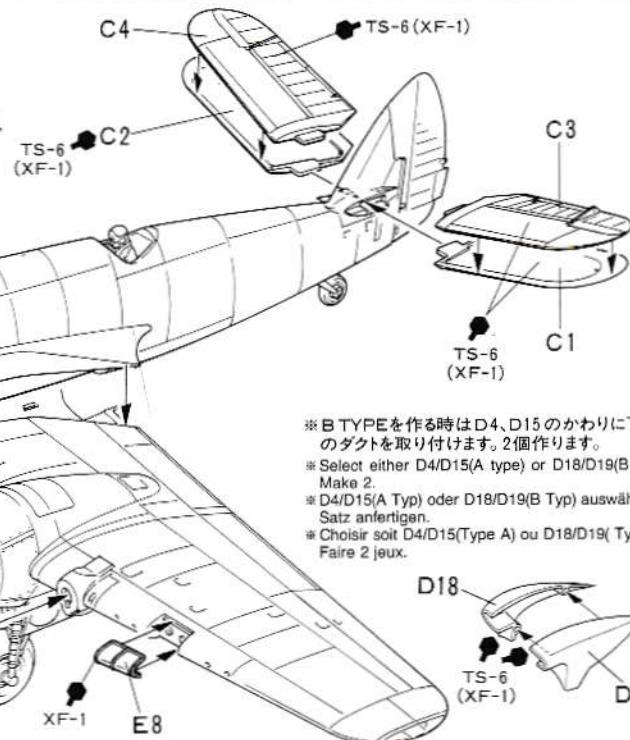
※ B TYPEを作る時はD4,D15のかわりに下のダクトを取り付けます。2個作ります。
