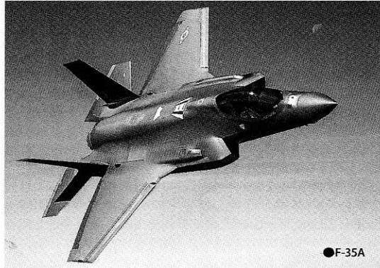
performances comparables à celles d'un biréacteur type F/A-18 Hornet, et l'emport de carburant offre un rayon d'action comparable à celui d'un F-15 équipé de réservoirs externes. Le F-35 a une vitesse maxi de Mach 1,6 et les commandes de vol électriques avec actionneurs électro-hydrostatiques assurent une excellente réactivité aux ordres du pilote.
