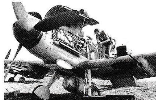
弾薬補給中のBf109 G-6。翼下にMG151/20ゴンドラキットを装備している。
